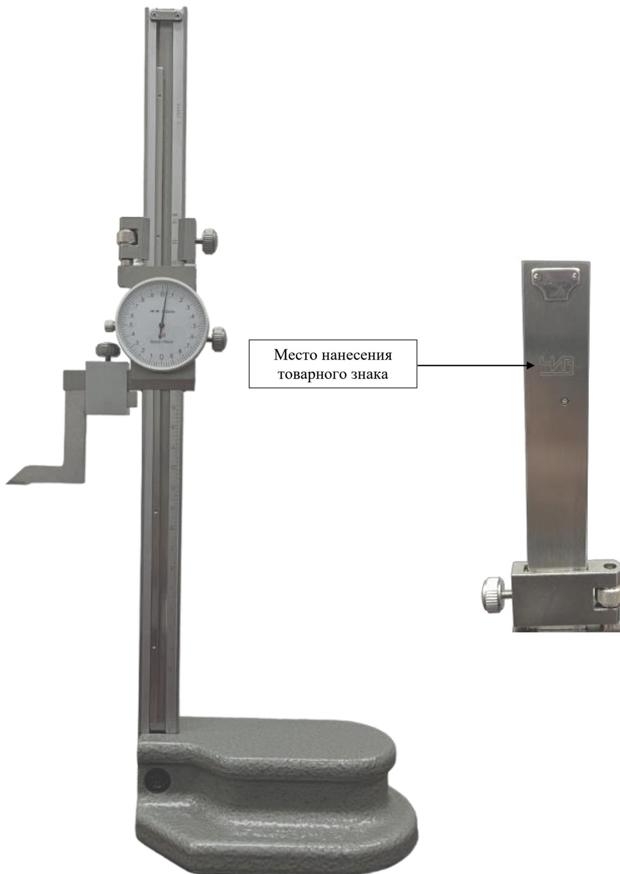
Рисунок 6 – Общий вид штангенрейсмасов модификации ШРК
