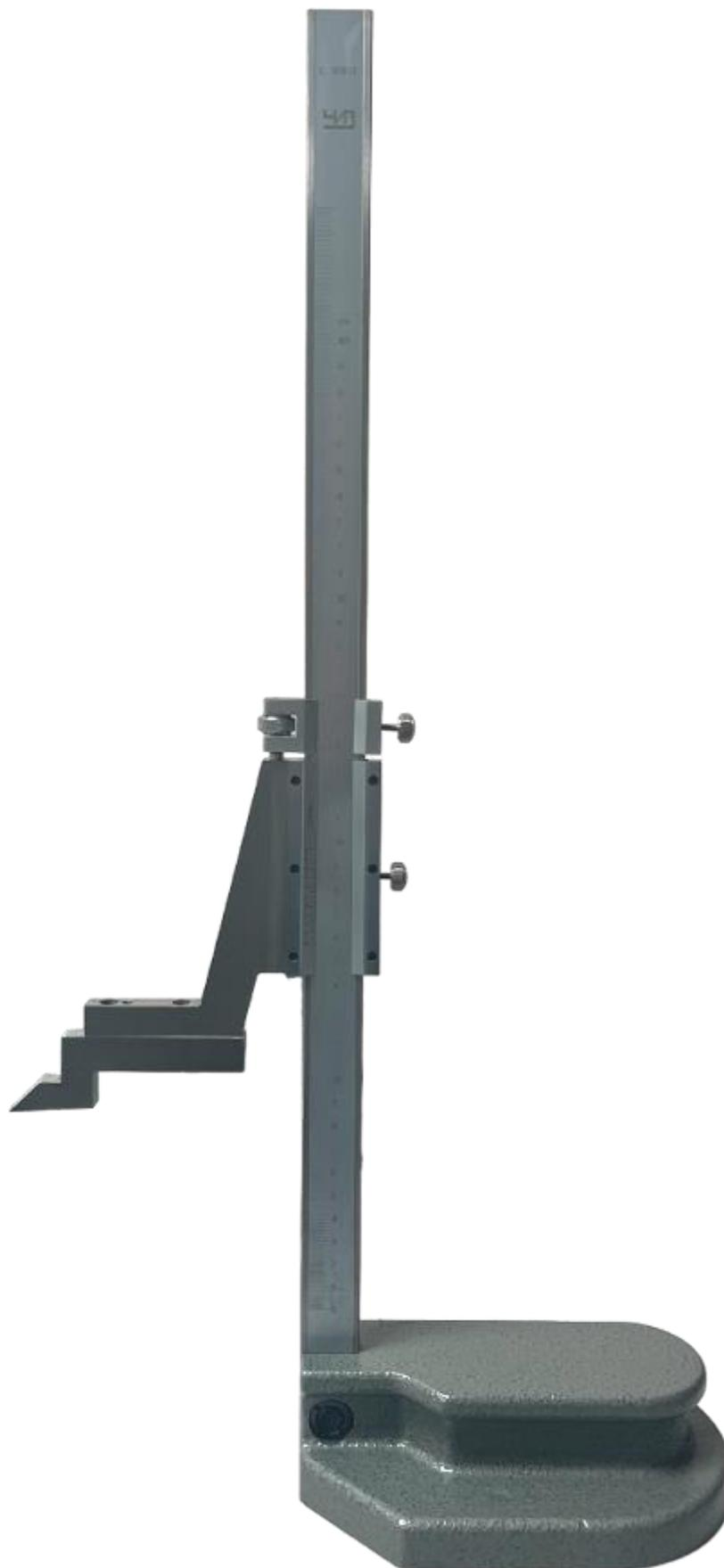
Рисунок 2 – Общий вид штангенрейсмасов модификации ШР
