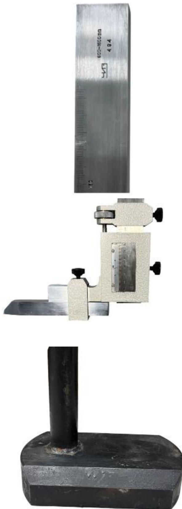
Рисунок 4 – Общий вид штангенрейсмасов модификации ШР
