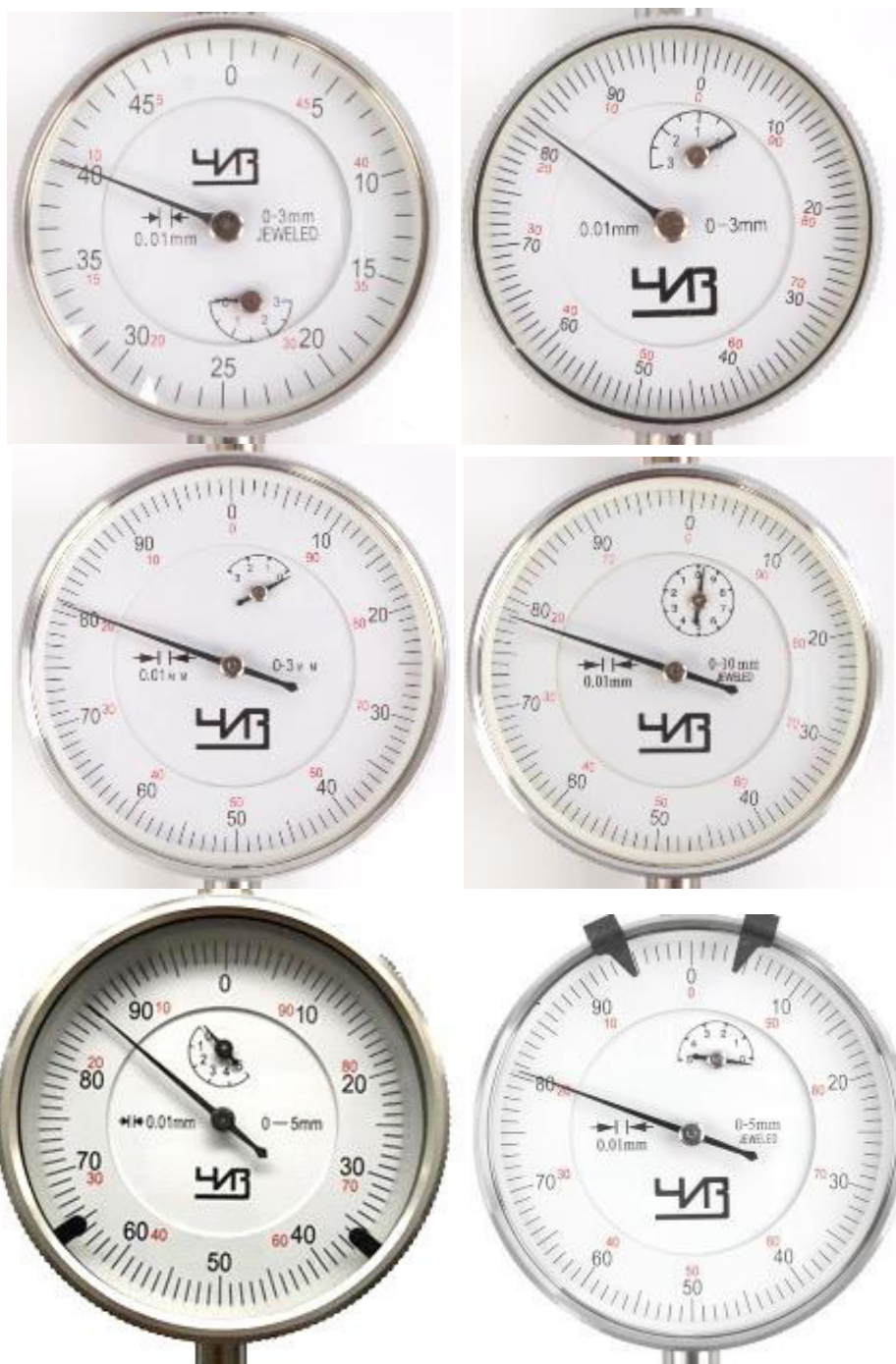
Рисунок 3 – Общий вид аналоговых отсчетных устройств, входящих в комплект нутромера
